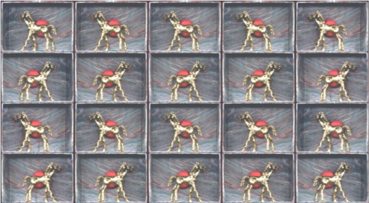
Bild 1: "Goldenes Pferdchen": Ein Messingpferdchen in einer Schachtel (BHT: 82 x 56 x 27 mm) wurde an verschiedenen seitlichen Positionen auf einem Flachbettscanner aufgenommen. In der obersten Reihe geben immer zwei benachbarte Bilder, mit gekreuzten Augen betrachtet, ein stereoskopisches Bild (Weitere Einzelheiten s. Text).*
