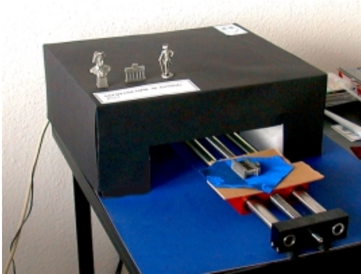
Bild 7: Der Stereo/3D-Scanner RSS I [2] beim Einscannen von kleinen Objekten aus dem Souvenirbereich. Friedrich II muss sich noch ca. 10 min gedulden, bis er an der Reihe ist. So lange wird es noch etwa dauern, bis die 12 Ansichten des Brandenburger Tors aufgenommen sind.
